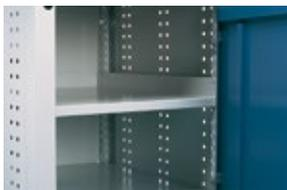
Fond avec rebord sur trois côtés, hauteur du rebord 52 mm, épaisseur du fond 25 mm, réglable en hauteur au pas de 30 mm.
